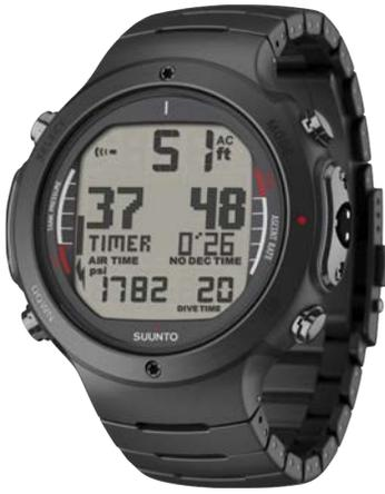
ra de buceo es prevenir la enfermedad de descompresión (DS). Este objetivo generalmente se logra mediante el diseño de un modelo matemático que simula el proceso de la absorción y de liberación de nitrógeno, haciendo el conteo de los factores que determinan la velocidad de la saturación y desaturación de varios tejidos.
